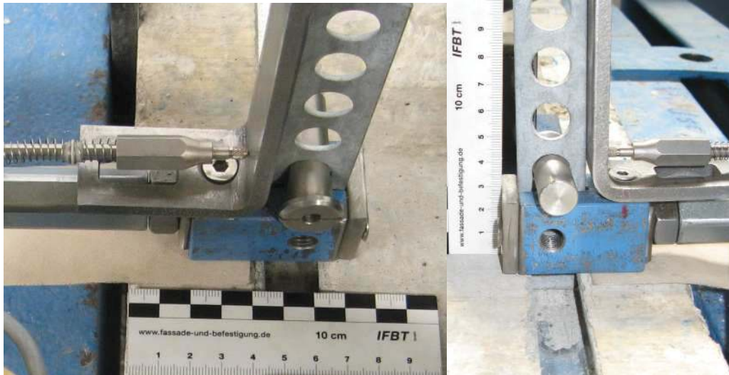
Bilder 4-5: Versuchsaufbau Querzug (VR 2) nach [1]
